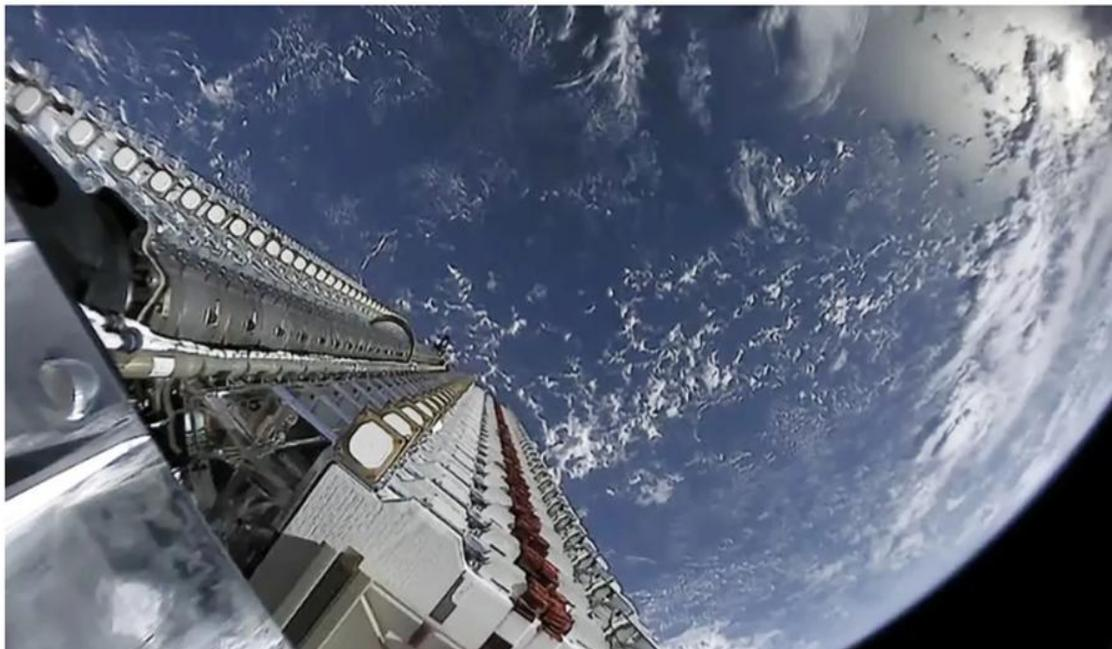
Рисунок 1.2 – Телекоммуникационный спутник Starlink
